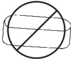
Les bouchons d'étanchéité d'Enphase sont classés IP67. Dans le terme "IP67", "IP" indique une classification de protection (Indice de Protection) contre la pénétration de poussières et liquides. Cette classification spécifique IP67 indique que ce connecteur est protégé contre toutes les particules de poussière et l'immersion dans un liquide.
