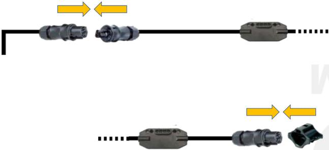
Branchez le connecteur mâle du câble Engage avec le connecteur femelle du câble de 10 m. **Vous devez entendre un déclic lorsque la prise s'enclenche.** Brancher ensuite le deuxième câble Engage au premier de la même façon et ainsi de suite. Au bout du dernier câble Engage, vérifier que le bouchon soit bien enfoncé pour garantir l'étanchéité du connecteur femelle.
