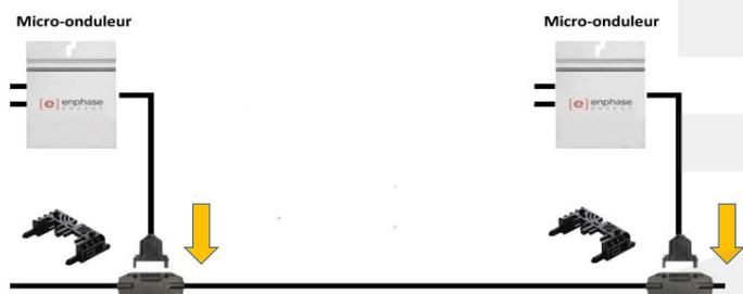
Retirez les capuchons de transport temporaire de chaque connecteurs du câblage Engage et branchez y chaque micro-onduleurs. Deux mécanismes de verrouillage sont intégrés à chaque connecteur. **Vous devez entendre deux déclics lorsque les connecteurs s'enclenchent**. Si vous avez besoin de les déconnecter, veuillez utiliser l'outil de déconnection fourni avec le Kit.
