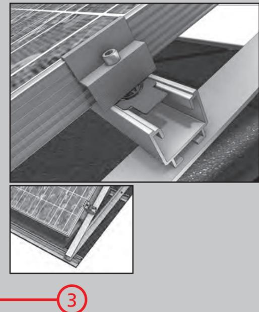
Couple de serrage recommandé pour vis métriques: M6: 6 Nm | M8: 16 Nm | M10: 32 Nm | M12: 56 Nm
