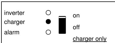
De netspanning is doorgeschakeld en de lader staat in bulk of absorption mode.
