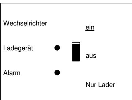
Die Wechselspannung ist durchgeschaltet und das Ladegerät ist abgeschaltet. Das Ladegerät erreicht nicht die Sollspannung (bulk protection Modus).
