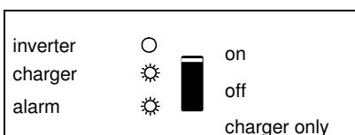
De netspanning is doorgeschakeld en er is een vooralarm: overbelast of de lader is warm.
