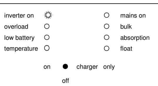
Opm: Wanneer de LED's "overload" en "low battery" tegelijk branden is apparaat uitgeschakeld tgv te hoge rimpel op de gelijkspanning.
