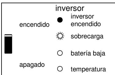
La salida nominal del inversor se ha superado. El LED indicador de "sobrecarga" parpadea.
