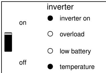
Der Wechselrichter hat sich wegen erhöhter Gerätetemperatur abgeschaltet.
