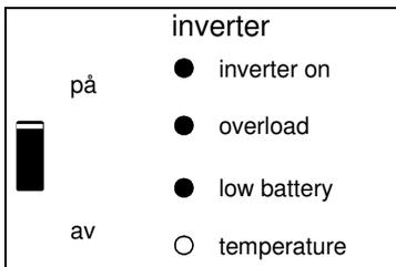
Växleriktaren har stängts av på grund av för hög brumspänning på batteriterminalerna.
