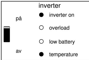
Växleriktaren har stängts av på grund av att elektronik temperaturen är för hög.
