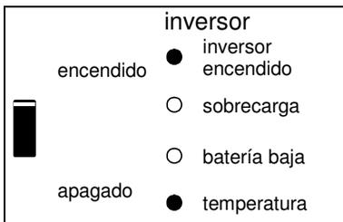
El inversor se ha apagado debido a que la temperatura de los componentes electrónicos es excesiva.
