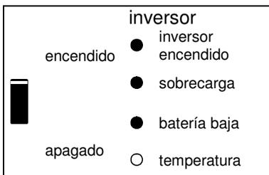
El inversor se ha apagado debido al exceso de tensión de ondulación en los terminales de la batería.
