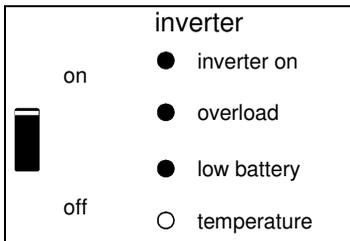
De omvormer is uitgeschakeld vanwege een te hoge rimpelspanning op de accuaansluiting.
